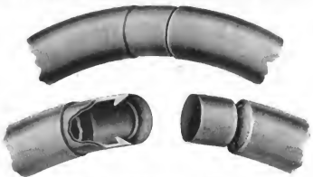
Fig. 2. Geteilter Excelsior-Schlauch für das Hinterrad der Motorräder.
